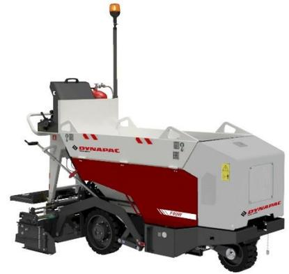
Der Dynapac F80W und die Vibrationsbohle V1300V sind ab Q4/2018 erhältlich. In Kombination mit den Dynapac Walzen CC800/CC900 und DTR75 gewährleistet der Dynapac F80W Straßenfertiger eine hervorragende Oberflächenqualität und eine gleichmäßige Verdichtung. Dank seines geringen Gewichts von nur 1,2 Tonnen und seinen kompakten Abmessungen kann der F80W zusammen mit weiteren Geräten auf nur einem Tieflader transportiert werden.
