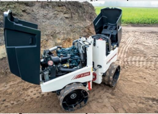
Die Grabenwalze D.ONE ist der Profi für den Graben. Mit einem Gewicht von 1,6 t und einer Zentrifugalkraft von max. 72 kN ist sie die perfekte Lösung für die Verdichtung von bindigem Material. Dank der Knick-Lenkung ist sie auch in beengten Bereichen sehr wendig. Optional ist die Grabenwalze D.ONE mit der Verdichtungsanzeige Dynapac Compaction Indicator (DCI) erhältlich.
