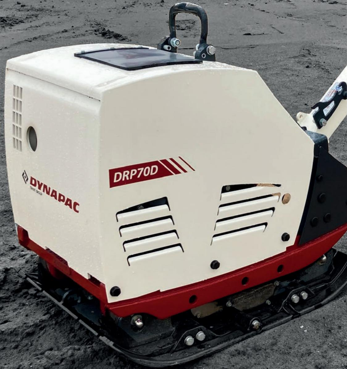
Die reversierbaren Vibrationsplatten der DRP-Serie überzeugen durch ihre ausgezeichnete Verdichtungsleistung und ein hohes Maß an Effizienz. Sie eignen sich hervorragend für die Verdichtung größerer Flächen. Durch ihre robuste Bauweise und Vollverkleidung kommen sie auch mit extremen Einsatzbedingungen mühelos zurecht.
