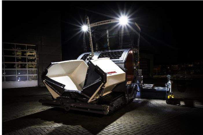
ebenfalls einen Dynapac Beschicker nutzen, sind bereits mit dem Coming Home Light vertraut und schätzen es wegen der sicheren und einfachen Bedienbarkeit der Maschine sehr. Der Motor muss nicht gestartet werden, denn die Rücklichter starten gleich mit Einschaltung des Hauptschalters, was einen sicheren Auf- und Abstieg gewährleistet und einen effizienten Betrieb sicherstellt.
