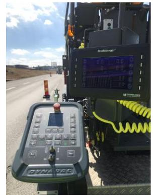
Durch das Qualitätssicherungssystem können die Arbeitsabläufe des Einbauprozesses optimiert werden, da festgehalten wird, wie viele Kilogramm pro Quadratmeter eingebaut wurden und wie oft gestoppt, beladen und gestartet wurde. Dies ermöglicht eine bessere Eigenkontrolle, die durch die Analyse- und Reportingfunktionen unterstützt werden. So
