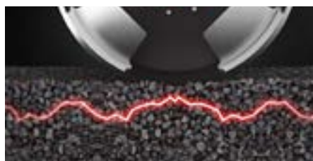
Verdichtung mit konventioneller Festfrequenz.
